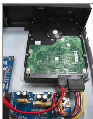
步驟 4：將硬碟兩側的螺絲孔對準支架的螺絲孔 (如下所示)，然後使用隨附螺絲將硬碟鎖在支架上。
